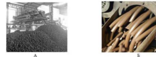
Рисунок 7.5 — Промышленная фабрика по производству «брэсков» — штабелирование «брэсков» (А); Разгрузка «брэсков» из экструдера (Б)
