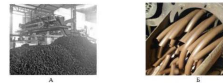
Рисунок 7.5 — Промышленная фабрика по производству «брэкссов» — штабелирование «брэкссов» (А), Разгрузка «брэкссов» из экструдера (Б)
